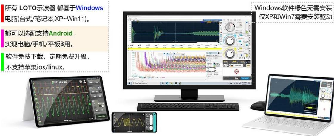
示波器与电脑PC/手机/平板之间，仅用一根USB线连接，不需要另加电源供电。USB协议，非无线连接。
