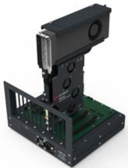
P5563A PCIe Gen5 测试背板， 其上安装有分析仪和被测器件
